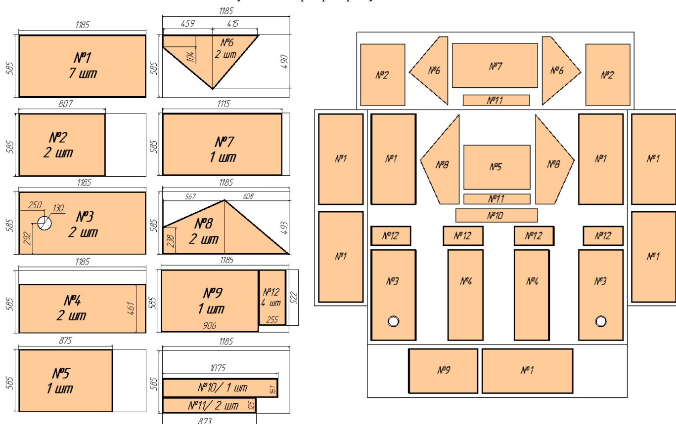
Рисунок 7 – Карта раскроя утеплителя
